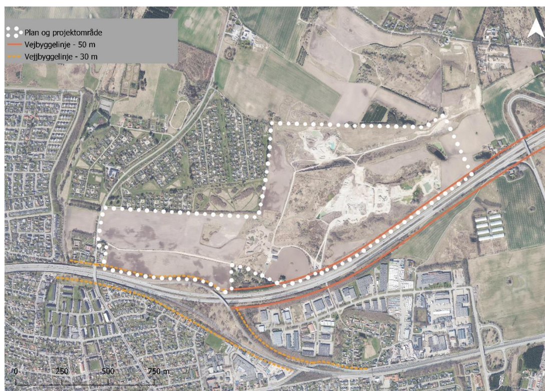
Figur 3.27 – Vejbyggelinje omkring Holbækmotorvejen på 50 og 30 meter. Indeholder data fra Styrelsen for Dataforsyning og Effektivisering, Ortofoto, WMS-tjeneste.
